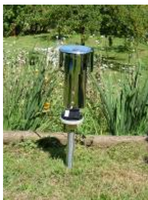
Photographie 1 : Capteur de pollen de type 'Sigma2' utilisé dans les études de quantification des coûts de la lutte à Estrablin et en Côte d'Or.
